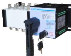
CFQ3 系列PC级自动双电源自动转换开关(以下简称开关)主要用于交流 50Hz、额定工作电压至400V，额定电流至630A及以下的三相四线制的供电系统，在供电系统电源电压异常期间中断向负载供电，随后将负载手动或自动切换至备用电源，适用于要求两路电源供电和对电源质量要求高的场合。广泛的应用于医院、商场、银行、高层建筑、电信、矿业、高速公路、机场、工业流水线、及军事设施等。
