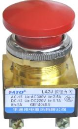
LA2系列按钮开关适用于交流50Hz、额定工作电压AC380V、额定电流2.5A或直流额定工作电压DC220V、额定电流0.3A的电气控制电路中，作为接触器、电磁起动器、继电器等电磁开关的控制、工作信号转换，电气联锁使用。
